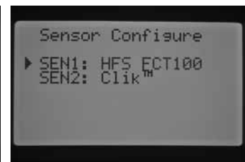
SEN 1 – DURCHFLUSSSENSOREN (HFS FCT100) SEN 2 – CLIK-SENSOREN
