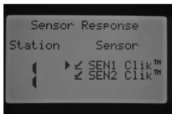
Beide Sensoren sind für Station 1 programmiert
