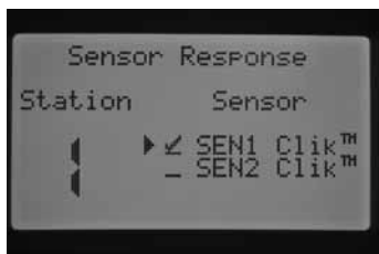
Nur Sensor 1 ist für Station 1 programmiert
