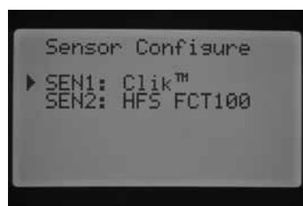
SEN 1 – CLIK-SENSOREN SEN 2 – DURCHFLUSSSENSOR (HFS FCT100)
