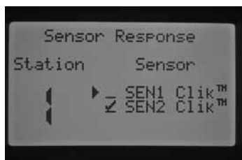
Nur Sensor 2 ist für Station 1 programmiert
