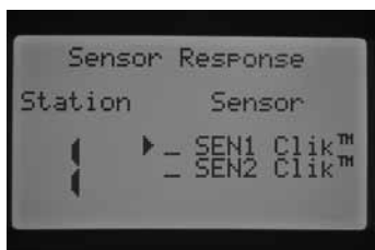
Kein Sensor ist für Station 1 programmiert
